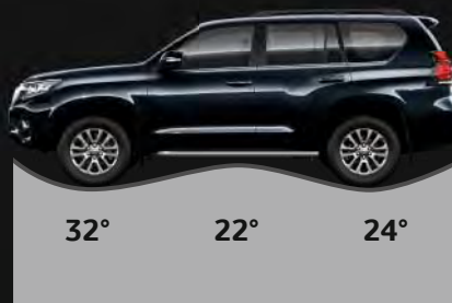
Lähestymiskulma, ylityskulma ja jättökulma
